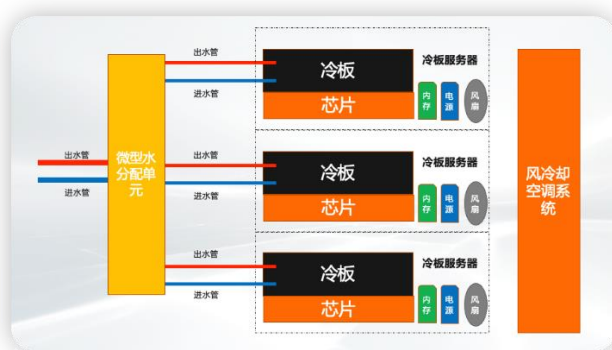
图 8：冷板服务器方案系统原理图
