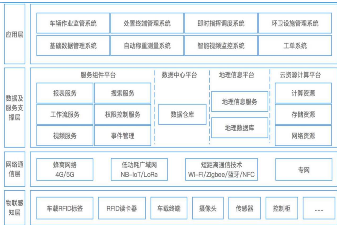
图 17：智慧环卫系统结构示意图
